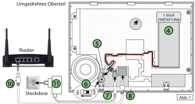
Anschluss an das Strom- und Datennetz.
